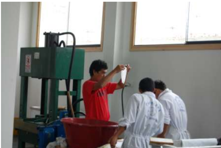
La separazione dei fogli dalla posta dopo la pressa
